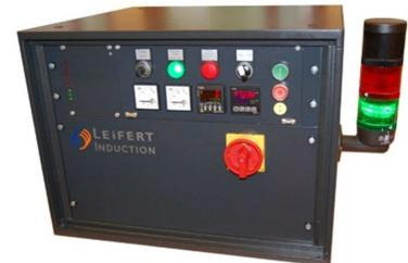
Moderne, in IGBT-Transistortechnik aufgebaute Mittelfrequenzgeneratoren ermöglichen vielfältige Anwendungen. Die Bedienung der Generatoren erfolgt wahlweise über klassische Taster oder über ein digitales Eingabegerät. Das Abfahren von Temperaturprofilen, die Regelung vorgegebener Temperaturwerte an mehreren Messstellen oder einfache Zeitsteuerung sind problemlos realisierbar. Hierbei stehen sowohl eine Reihe standardisierter Geräte als auch kundenspezifische Module zur Verfügung.
